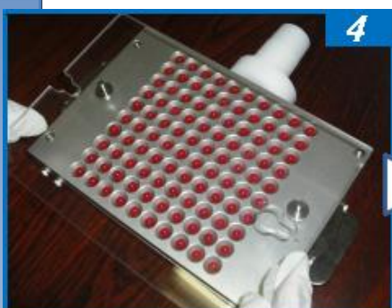
4.キャップカバーを上部にセットします
