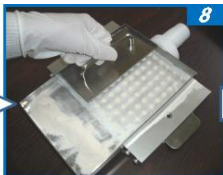
8.タンパーで押し固め 再度充填
