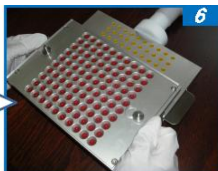
6.キャッププレートを外します
